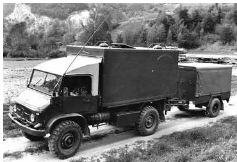
Véhicule du poste central de tir de batterie 83.
