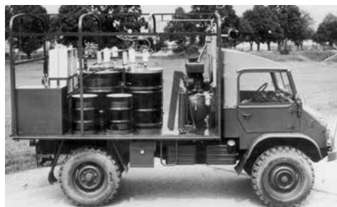
Véhicule de maintenance avec ses réserves de lubrifiants et de graisses.
