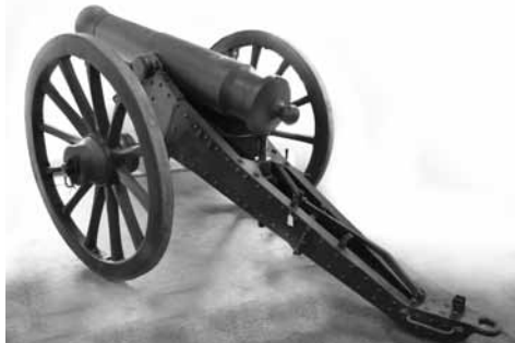
Rohr der langen 24-pfdr-Haubitze Ord 1850 auf Lafette der 12-pfdr-Positionskanone Ord 1869 (Zustand mit falscher Eisenlafette bei der Einlagerung 1966 in Sarnen)
