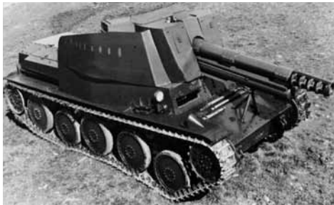
Nahkampfkfkanone I (NKK I), Stand 1944, ausgerüstet mit einer 10,5-cm-Haubitze.
