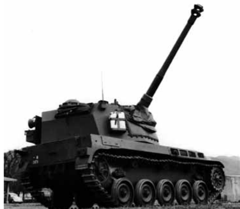
10,5-cm-Selbstfahrhaubitze AMX 13 mit Rohr in Maximal-elevation während der Schiesserprobung.
