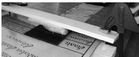
Befestigung der Auflagekartons mit organischem Kleber unter der Presse
