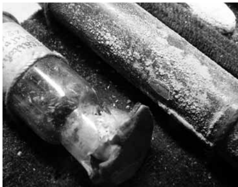
Versuchspatrone Modell 1898. Die zerbrochene Glasampulle, enthaltend das rauchlose Pulver und daneben die Messinghülse mit dem grünen Korrosionsprodukt (Grünspan)
