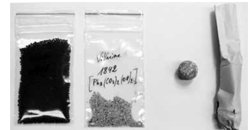
Zerlegte Patrone Modell 1842 aus der Eichenholzvitrine. In der Mitte das Korrosionsprodukt des Bleigeschosses
