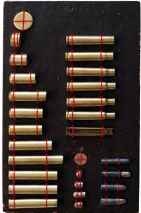
IV. Tableau, das die Fertigungsstadien einer Hülse und eines Geschosses des Kalibers 7,5 mm zeigt (1890)
