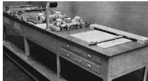
Abb. 1: Gesamtansicht des Integraphen von der Vorderseite im Ablieferungszustand. Von links: Tisch 1, Tisch 2 und Tisch 3
