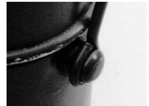
Abb. 12: Angenietete Knopfwarze (damit Henkel um 360 Grad schwenkbar)
