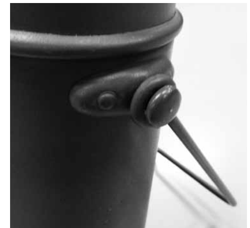
Abb. 16: Quer angenietete Henkelöse (Henkel immer noch um 360 Grad schwenkbar)
