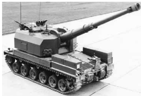
Canon blindé d'artillerie 15,5 cm 68, tel qu'engagé dans les essais à la troupe en 1972.
