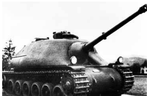
Canon de combat rapproché II (NKK II), état 1946, équipé d'un canon antichars 7,5 cm.
