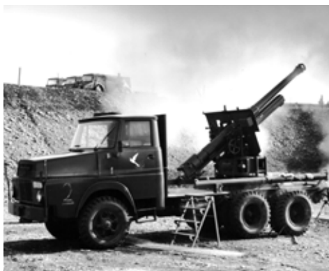
Canon 10,5 cm 1935, monté sur le châssis du camion Henschel, en activité de tir avec charge maximale, à l'occasion d'une présentation.
