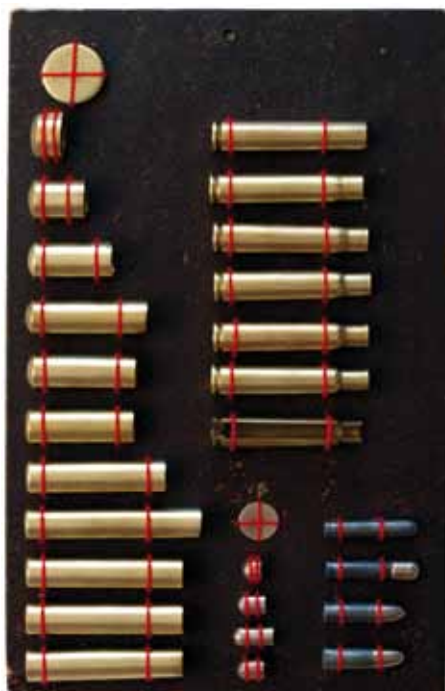
IV. Panneau décrivant les étapes de réalisation d'un étui et d'une balle calibre 7,5 mm (1890)
