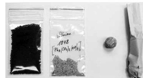
Eclaté de la cartouche 1842 suisse dans la vitrine en chêne. Au centre le produit de corrosion du plomb
