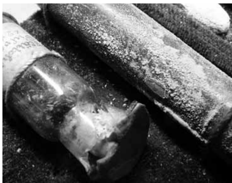
Cartouche d'essai Modèle 1898: la fiole en verre brisée contenant de la balistite et le produit de corrosion vert vif du laiton
