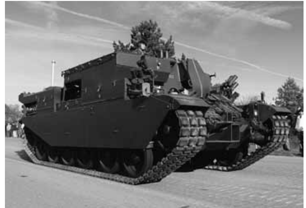
Ein seltenes Exemplar: Der Entpannungspanzer 56 auf dem Chassis des Centurion.
