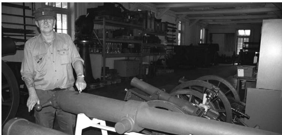
Rudolf Roth erklärt in der Artilleriehalle eine englische Armstrong-Kanone, das erste gezogene Hinterlader-Geschütz, welches offiziell in den Streitkräften überhaupt zur Ordonnanz erklärt und eingeführt wurde. Dieser 6-Pfünder, das kleinste Kaliber der Armstrong-Geschütze, dürfte weltweit das bisher einzige noch existierende Exemplar dieses Kalibers sein.
