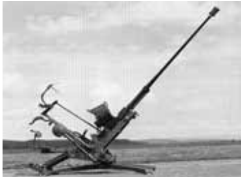
Can DCA 20 mm 54 avec viseur en verre plexi, en position de feu
