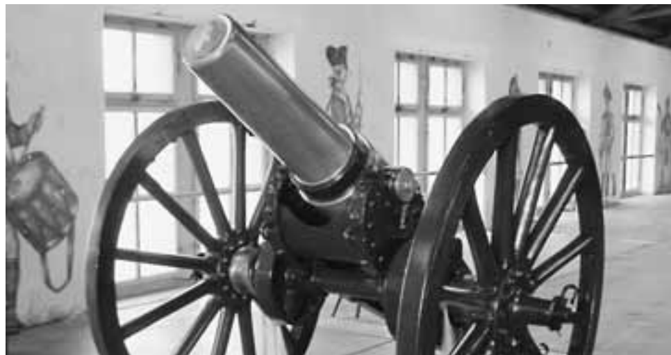
Mortier de position de 12 cm, ordonnance 1883, avec tube en bronze
