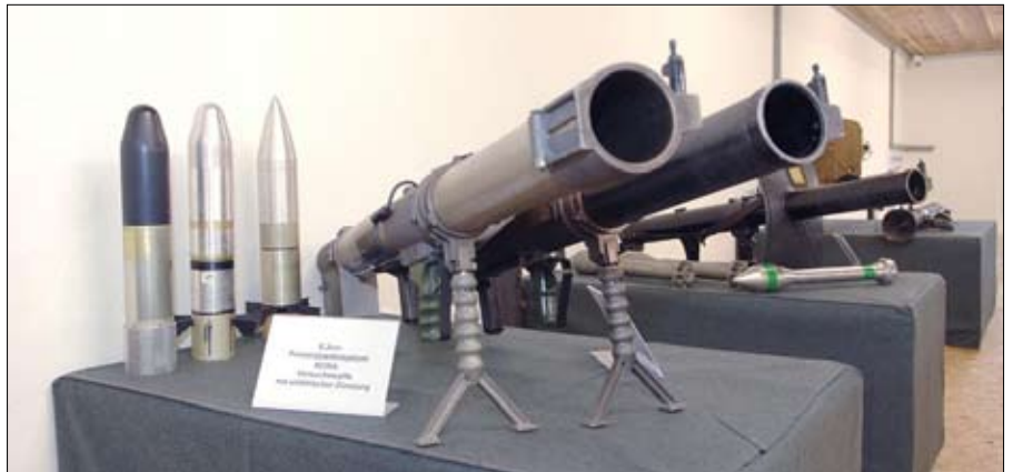
Bild 12: 8,3 cm Raketengeröhre NORA, links elektrische Zündung, rechts mechanische Zündung
