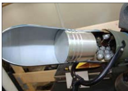
Bild 15: Übungslenkwaffe Dragon im Schnitt
