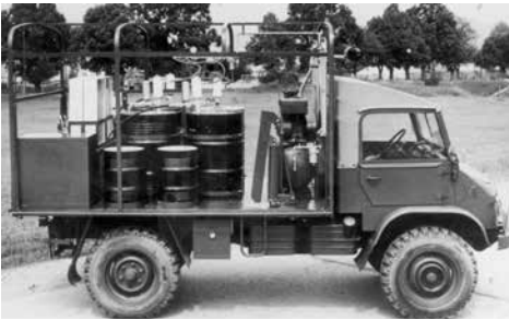
Wartungswagen mit Öl- und Fettreserven.
