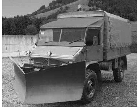
Unimog-S mit Keilflug, ein Fahrzeug der Festungswachkompanie 10.
