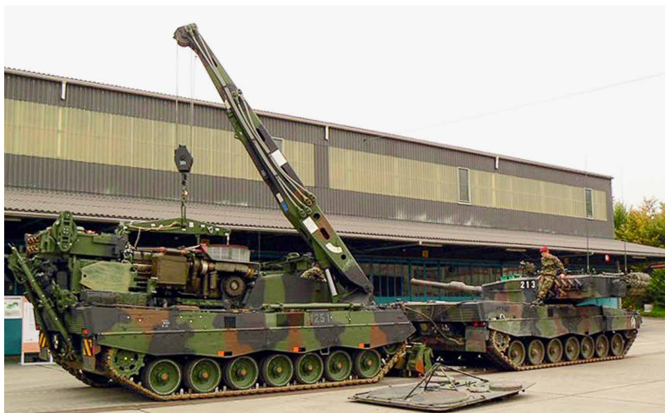
Char de dépannage Buffle en train de remplacer le moteur d'un char 87 Léopard.
