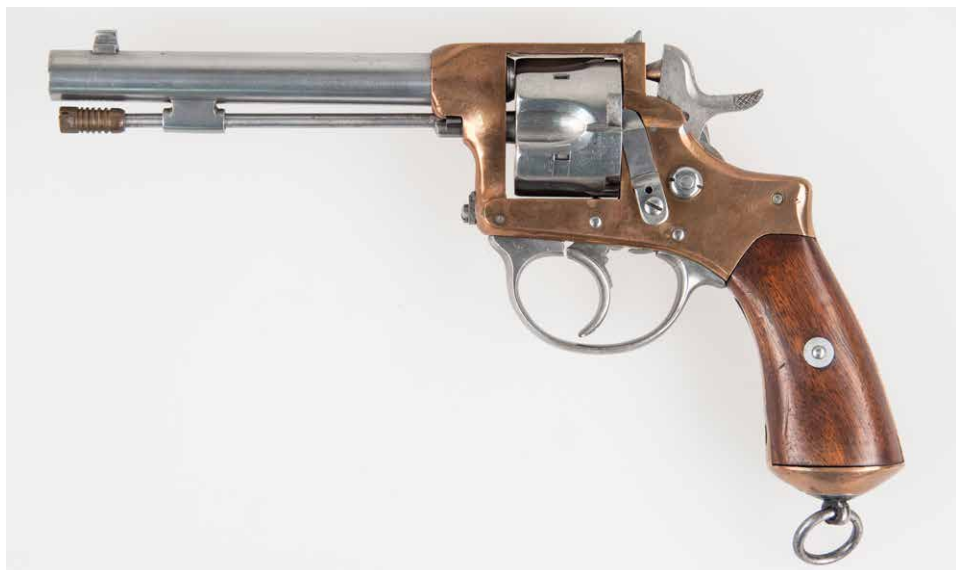
Revolver Küchlin, von Steiger, avec extracteur, essais 1876/1877, numéro d'arme 3, calibre 10 mm, cadre en bronze au phosphore, barillet à 5 coups.
