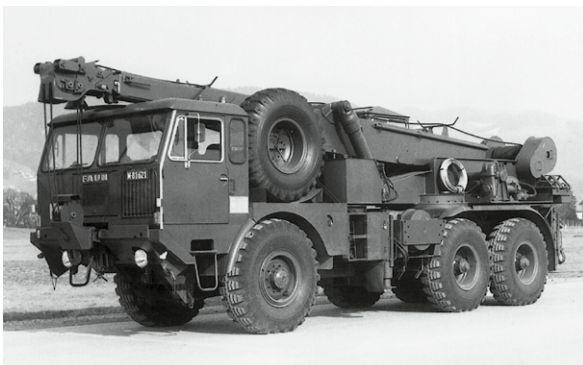
Faun LK 1508/36 modèle génie. La flèche télescopique est fixée à gauche sur le châssis.
