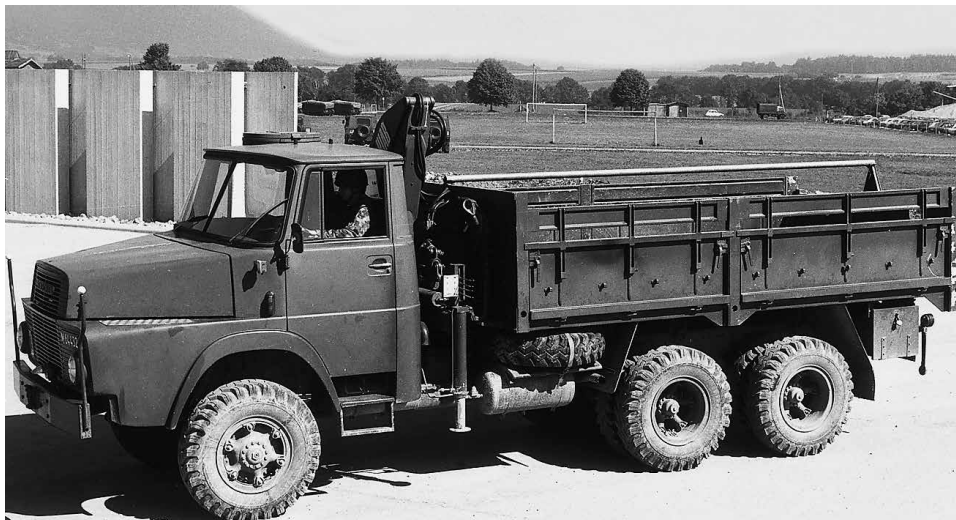
Henschel HS 3-14 HA-CH avec grue de chargement HIAB type 174, capacité de levage max. 3250 kg à une flèche de 1,7 m. HIAB (Hydrauliska Industri AB) développa la première grue de chargement en 1944 ; de nos jours, HIAB fait partie du groupe Cargotec, avec Loglift, Jonsered et Kalmar.
