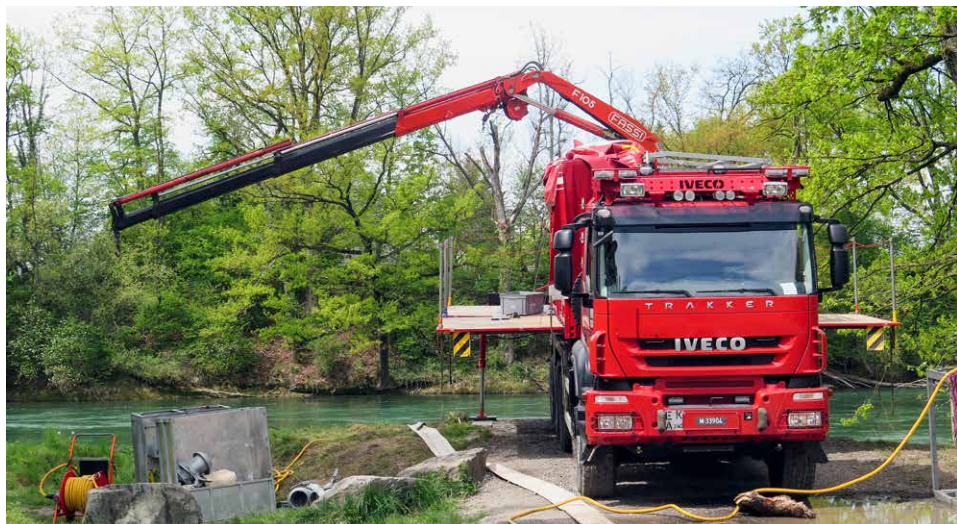
Iveco Trakker 500 avec WELAB 7 et grue à l'arrière Fassi F 135.
