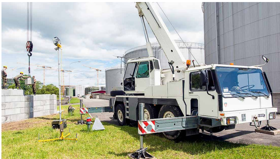
Camion-grue mobile Liebherr LTM 1040/1 6x6, catégorie de poids 40 t, cinq véhicules à l'engagement, à partir de 1995.
