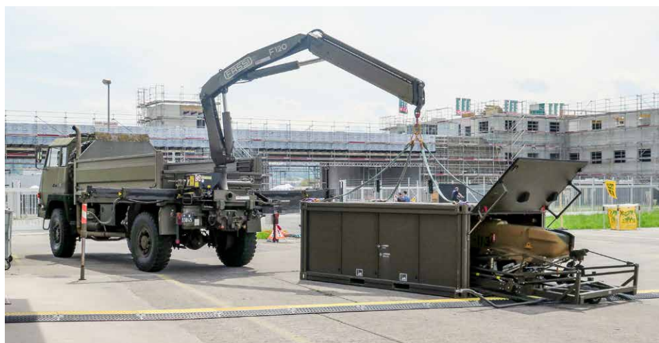
Steyr 1291.320 4x4 avec grue de chargement à l'arrière Fassi, avec treuil, attribué au système de drones de reconnaissance 95 (ADS 95). L'ADS 95 fut mis hors service à la fin 2019, et ce véhicule fut liquidé en 2020.
