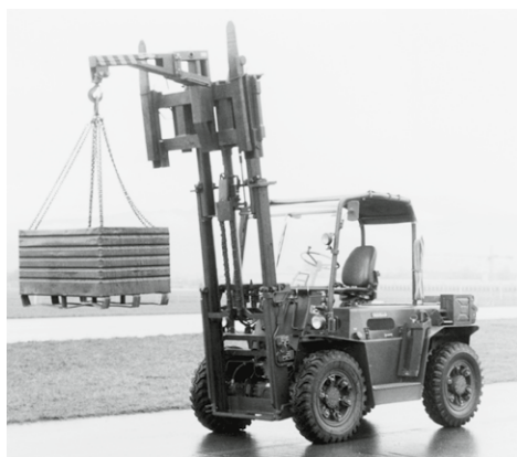
Steinbock DFG 2 SC – 4 WD avec bras de grue, capacité de charge maximale 2000 kg, hauteur de levage maximale 2960 mm.
