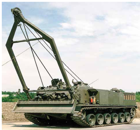
Char dépan 65, avec grue à l'avant, force de levage 15 t à 3 m.
